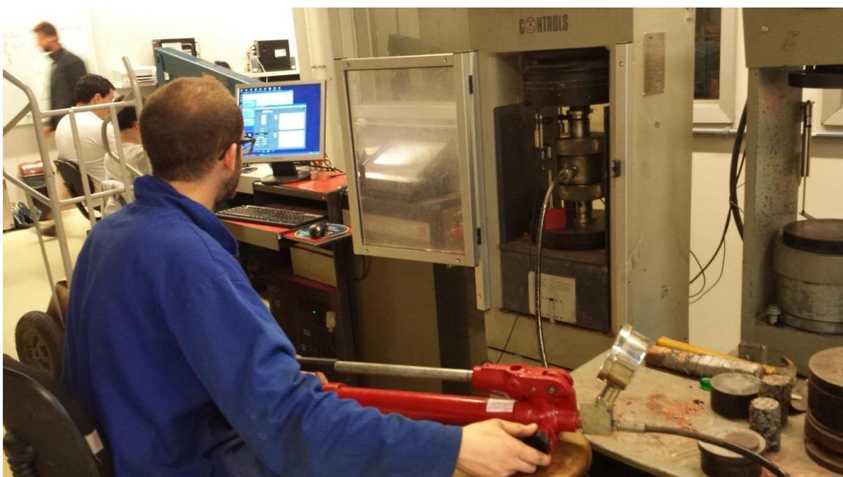
A definição das tensões confinantes foram escolhidas com base nas pesquisas já desenvolvidas neste mesmo aparelho de ensaio. A bibliografia recomenda tensões confinantes baixas e é necessário a realização do ensaio com ao menos 3 tensões para que possa ser gerada uma curva de onde serão retirados os parâmetros de cisalhamento. As tensões escolhidas foram de 0 kPa, 100 kPa e 200 kPa. O critério de finalização do ensaio foi o decréscimo ou estabilização da carga.
