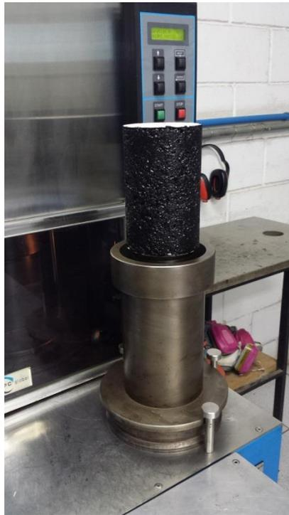
Figura 21 - Corpos de prova esfriando depois de serem compactados e desmoldados
