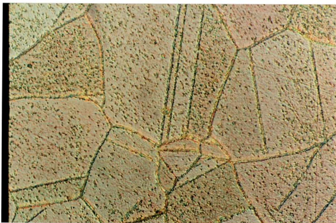
Figura 28 - Aspecto metalográfico para o aço AISI 304 envelhecido artificialmente, Solução A -5g \text{FeCl}_3 , 15 ml HCl e 60 ml de metanol (6 seg.) : aumento: .500X.
