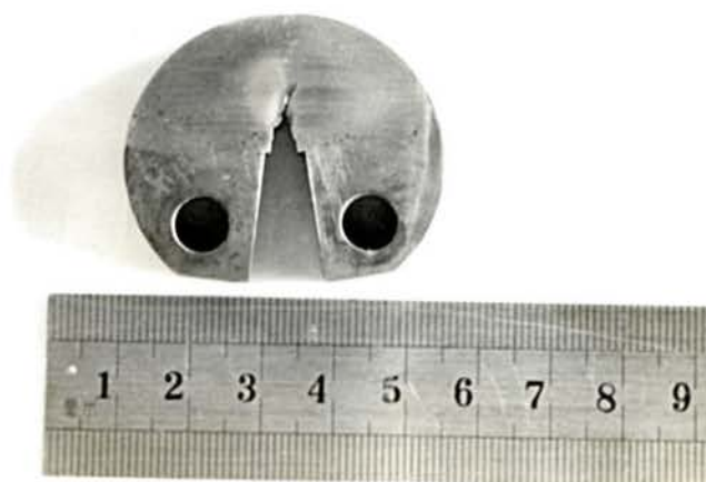
Figura 68 - Aspecto macrográfico da fratura do material usado em um ensaio interrompido.
