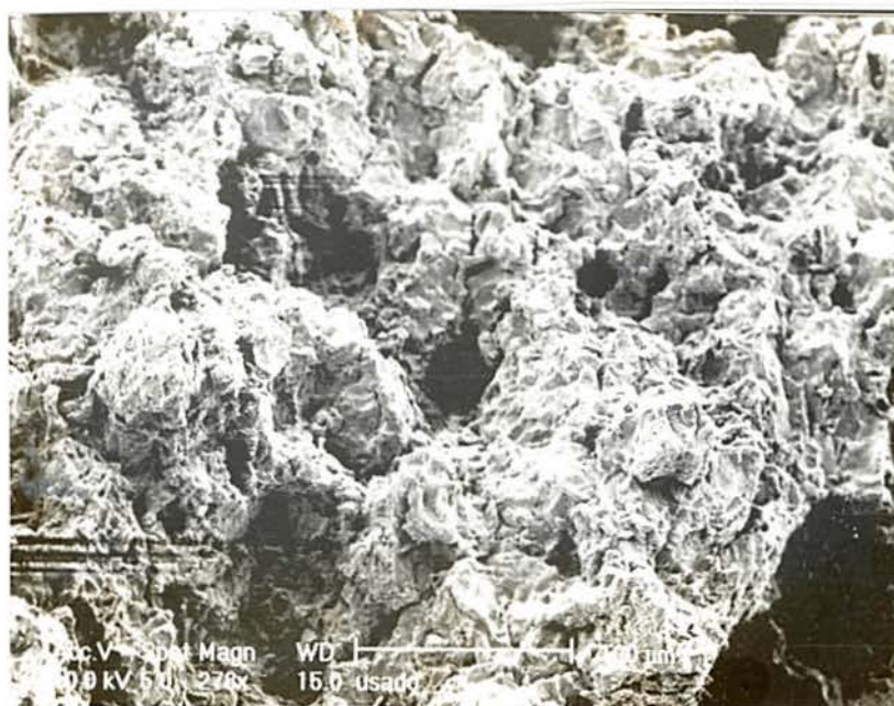
Figura 61 - Aspecto da fratura para material usado:aumento:278X.
