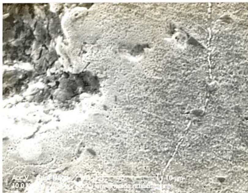
Figura 60 - Aspecto metalográfico da região a fim de explicar trincamento transgranular em material envelhecido artificialmente em ensaio interrompido :aumento:2864X.
