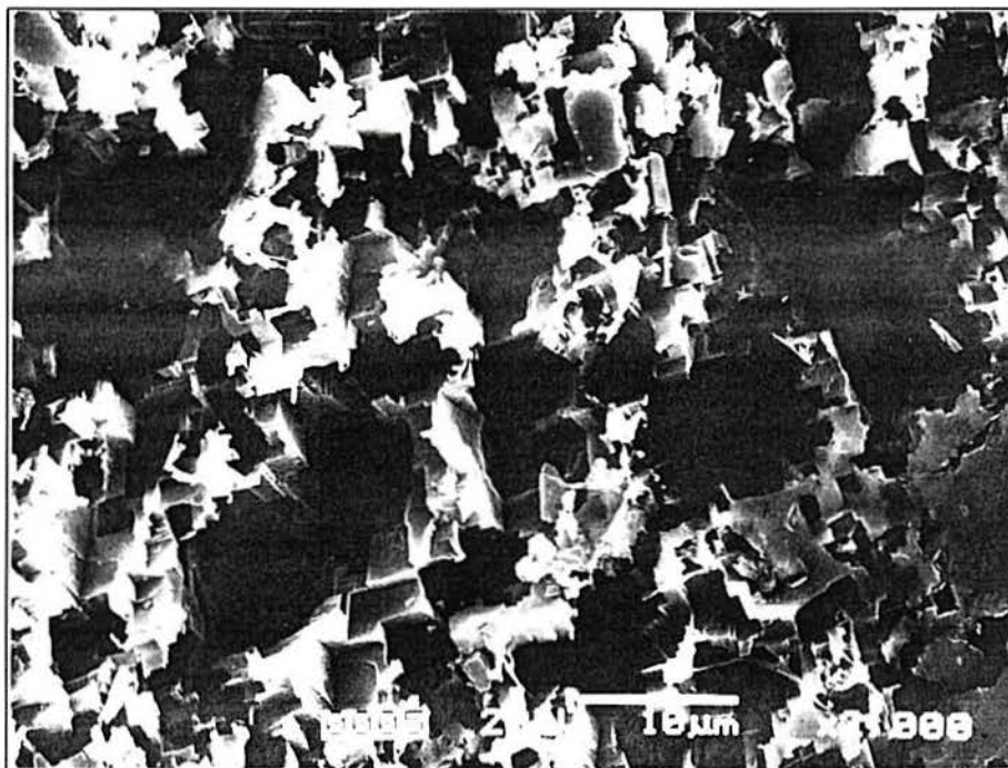
FIGURA 4.31: Micrografia do Al5N após ensaio galvanostático em solução 100% água/0,1mol/L NaCl. (MEV x2000)
