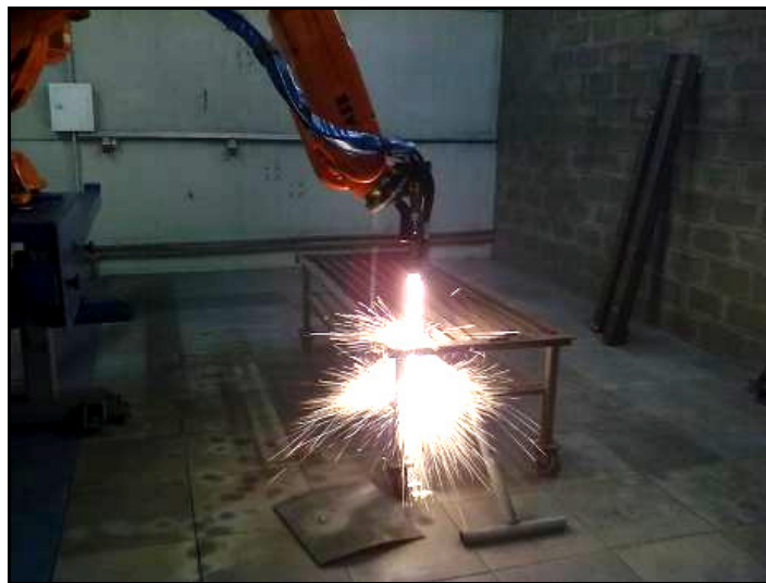
Figura 4-4 - Processo de Aspensão térmica pelo processo HVOF. Pistola de aspensão térmica HVOF (JUNIOR, 2011).
