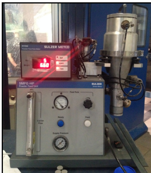
Figura 4-5 - Processo de Aspersão térmica pelo processo HVOF. Equipamento de controle de parâmetros operacionais de processo.
