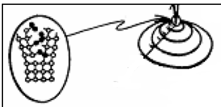
Figura 3-7 – Mecanismo de descoesão da rede cristalina (ORIANI, 1972).
