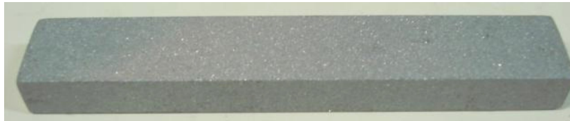
Figura 4-1- Corpo de prova retangular de aço API 5CT P110 na condição de jateado pronto para receber a aspersão térmica.
