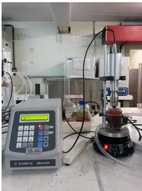
Figura 3.2 Sistema do pré-tratamento com ultrassom
