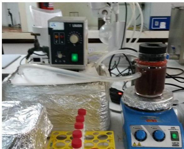
Figura 3.3 Sistema com banho termostático, agitador e célula encamisada onde ocorre a etapa de extração.
