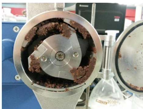
Figura 4.6 Interior do moedor após o processo de moagem do bagaço de uva úmido
