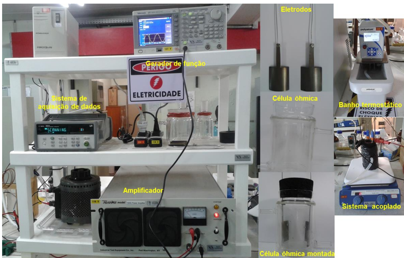
Figura 3.3: Configuração dos equipamentos utilizados no aquecimento ôhmico.
