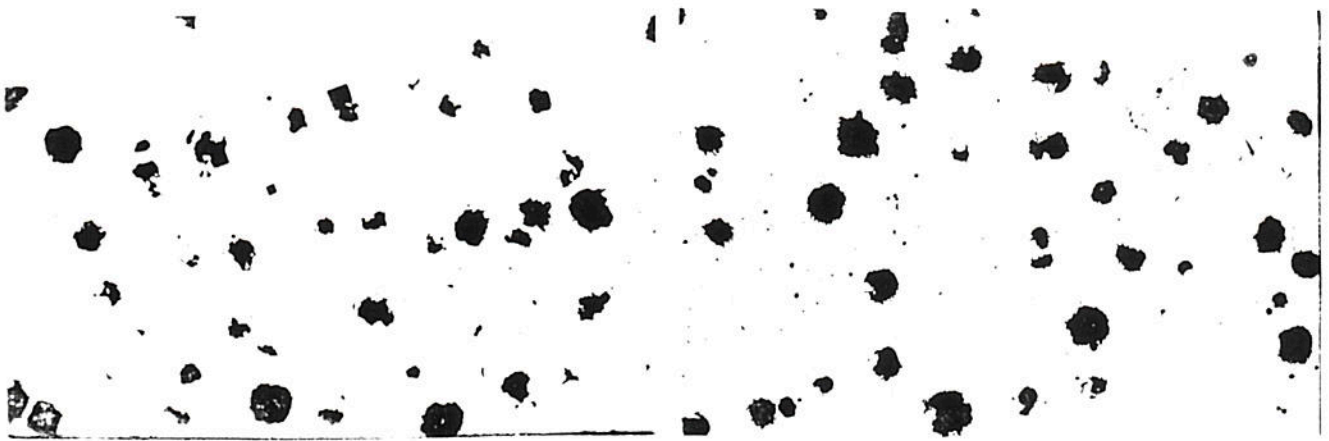
Maior "E" Figura 18 - Amostra 1 sem cobre/normalizada (100x) Grau de nodularização = 90% Tamanho de nódulos = 6 da ASTM Nódulos/mm 2 = 50
