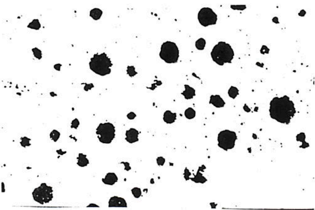
Maior "E" Figura 21- Amostra 4 1% cobre/normalizada (100x) Grau de nodularização = 90% Tamanho de nódulos = 5 e 6 da ASTM Nódulos/mm 2 = 50
