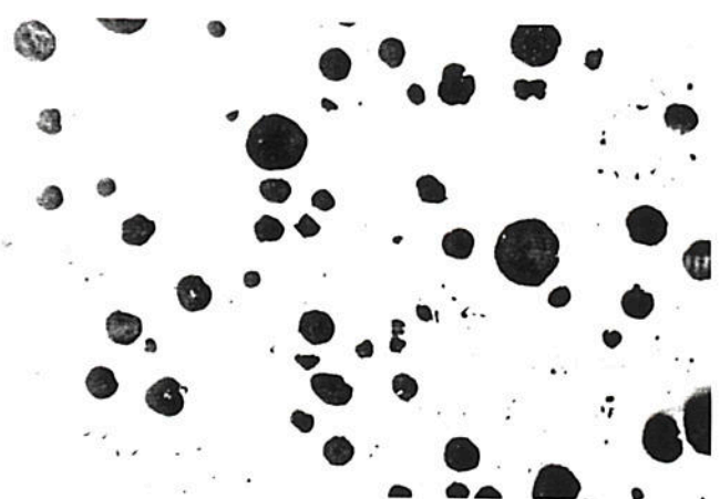
Menor "e" Figura 20(a) - Amostra 3 sem cobre/sem tratamento térmico Grau de nodularização = 90% Tamanho de nódulos = 5 e 6 da ASTM Nódulos/mm 2 = 50
