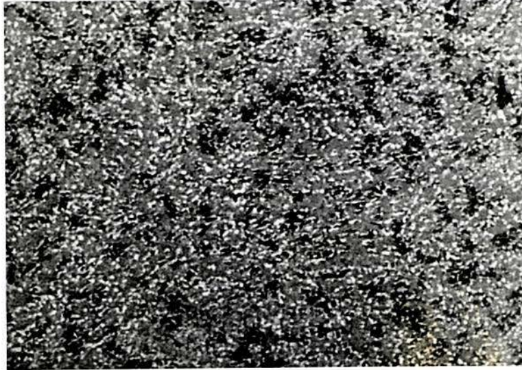
Figura 29- Microestrutura da Zona de Ligação da junta soldada do aço 2 ¼ Cr 1 Mo; Ataque : Nital 2 %; MEV 800x
