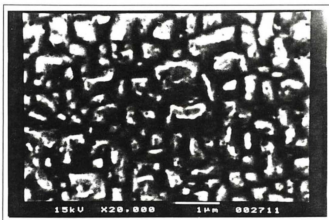
Figura 4.21 - Aspecto da superfície obtida após imersão em \text{NH}_4\text{F} 10M / pH 10 (amostra A / 1° ponto). Potencial aplicado -400 \text{ mV}_{\text{ecs}} por 3 horas e 34 minutos.
