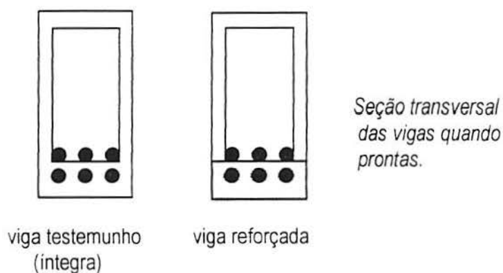
Figura 4.7 Representação esquemática da seção transversal dos dois tipos de vigas ensaiadas, testemunhos e reforçadas, após terem sido realizados os trabalhos de reforço.
