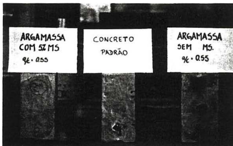
Figura 3.24 Estado dos corpos de prova após o ensaio de corrosão acelerada.
