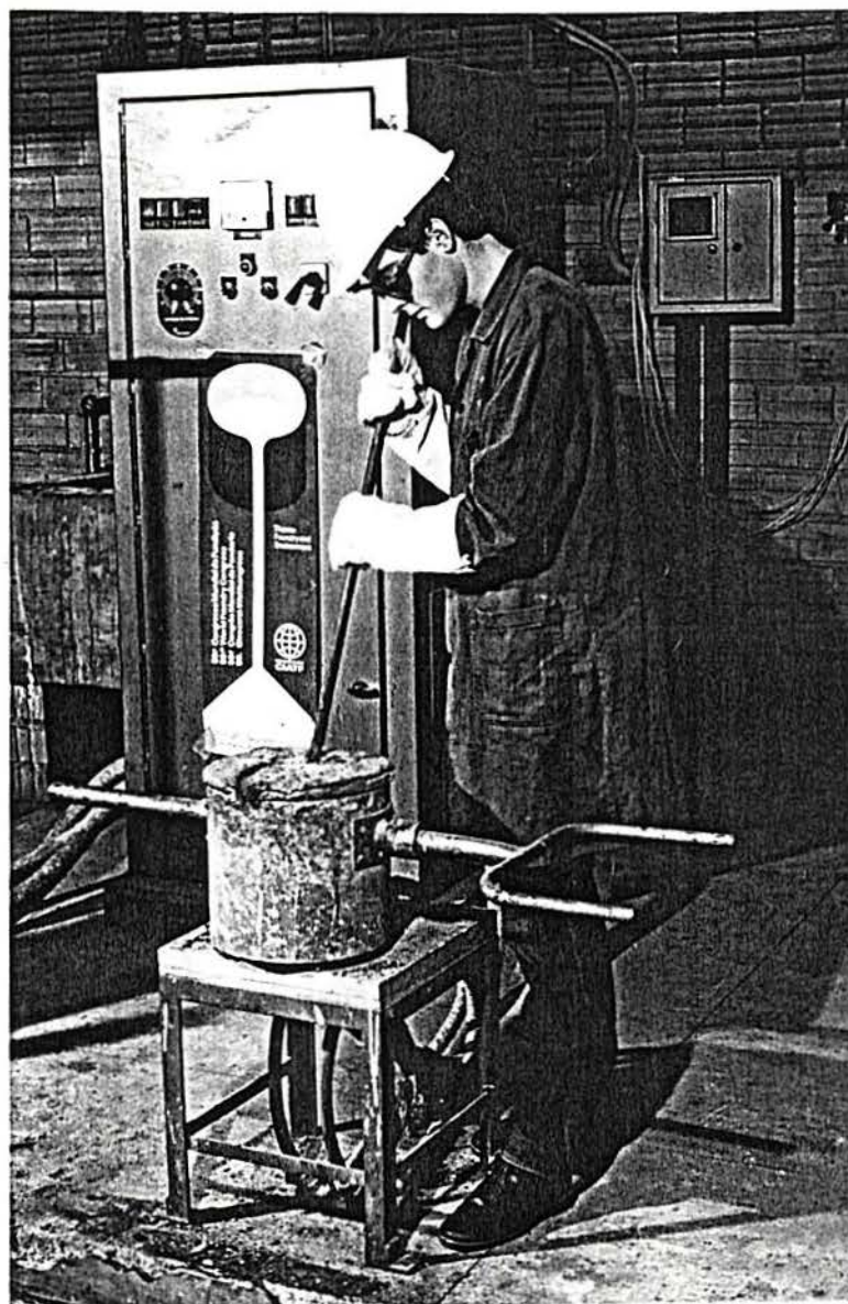
FIGURA 18 Fotografia da homogeneização do banho com bastões de aço.
