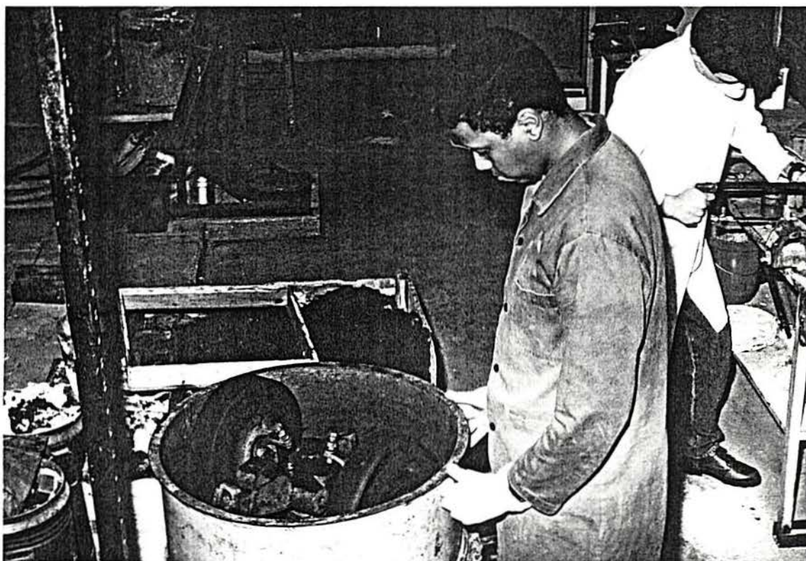
FIGURA 17 Fotografia da preparação do molde de areia, com misturador de mãos.
