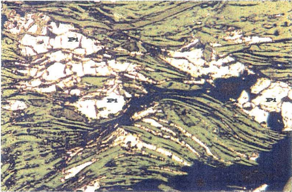
Figura 2 - Massa anédrica de pirrotita (Pi) disposta em meio aos leitos ricos em muscovita (Mu). Escala 1 cm = 0,16mm
