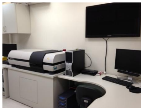
Figura 51: Microtomógrafo de Raios X com computador de gerenciamento.
