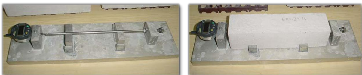
(a) Base horizontal comparadora, barra padrão e suportes acopláveis
