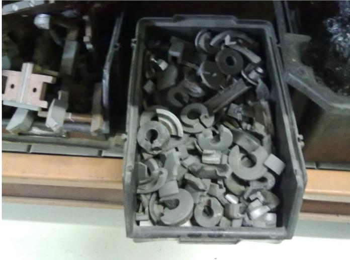
Figura 1.3: Perdas de material resultantes da usinagem
