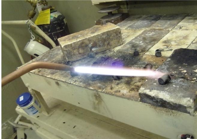
Figura 3.14: Simulação de aquecimento dos orientadores de fluxo
