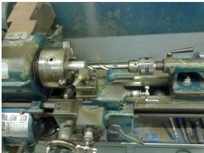
Figura 1.2: Orientador de fluxo sendo usinado
