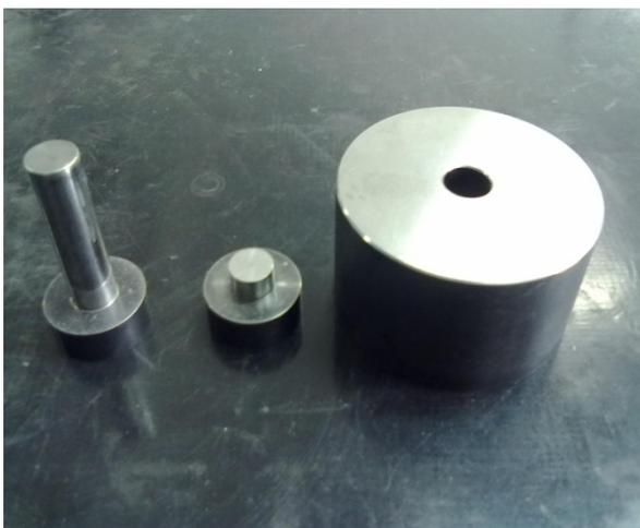
Figura 3.8: Matriz cilíndrica para compactação das amostras
