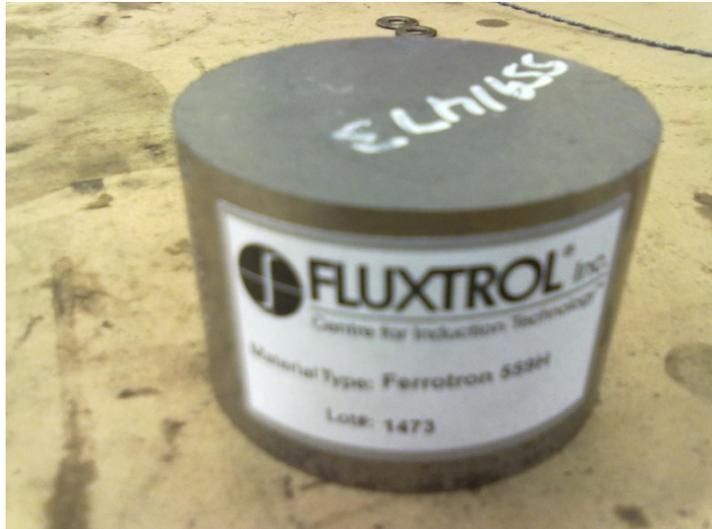
Figura 1.1: Orientador de fluxo no formato comercializado
