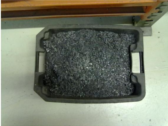
Figura 3.1: Cavaco de Ferrotron® usado
