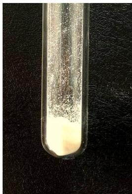
**Figura 14.** Fotografia do líquido iônico trifluorometanossulfonato de 1-hexadecil-3-metilimidazólio  $C_{16}MI.CF_3SO_3$ .
