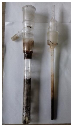
Figura 8. Partes do reator de quartzo (da esquerda para a direita): parte externa (entrada do gás inerte), compartimento da amostra e compartimento do termopar.
