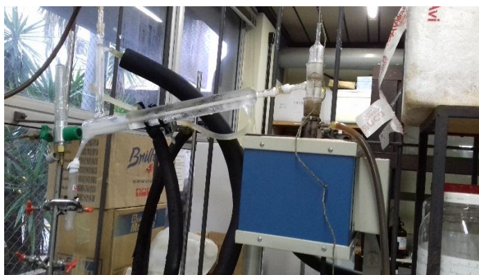
Figura 7. Reator de pirólise utilizado no processo de pirólise. Esquema completo do reator de pirólise rápida e suas conexões.
