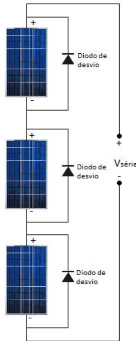
Figura 16. Associação série dos módulos fotovoltaicos com diodo de desvio.
