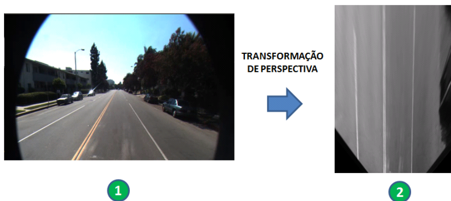
Figura 15: (1) A imagem da pista na escala de cinza e filtrada por um filtro de mediana e (b) A imagem de saída da transformação de perspectiva ( Bird's Eye ).
