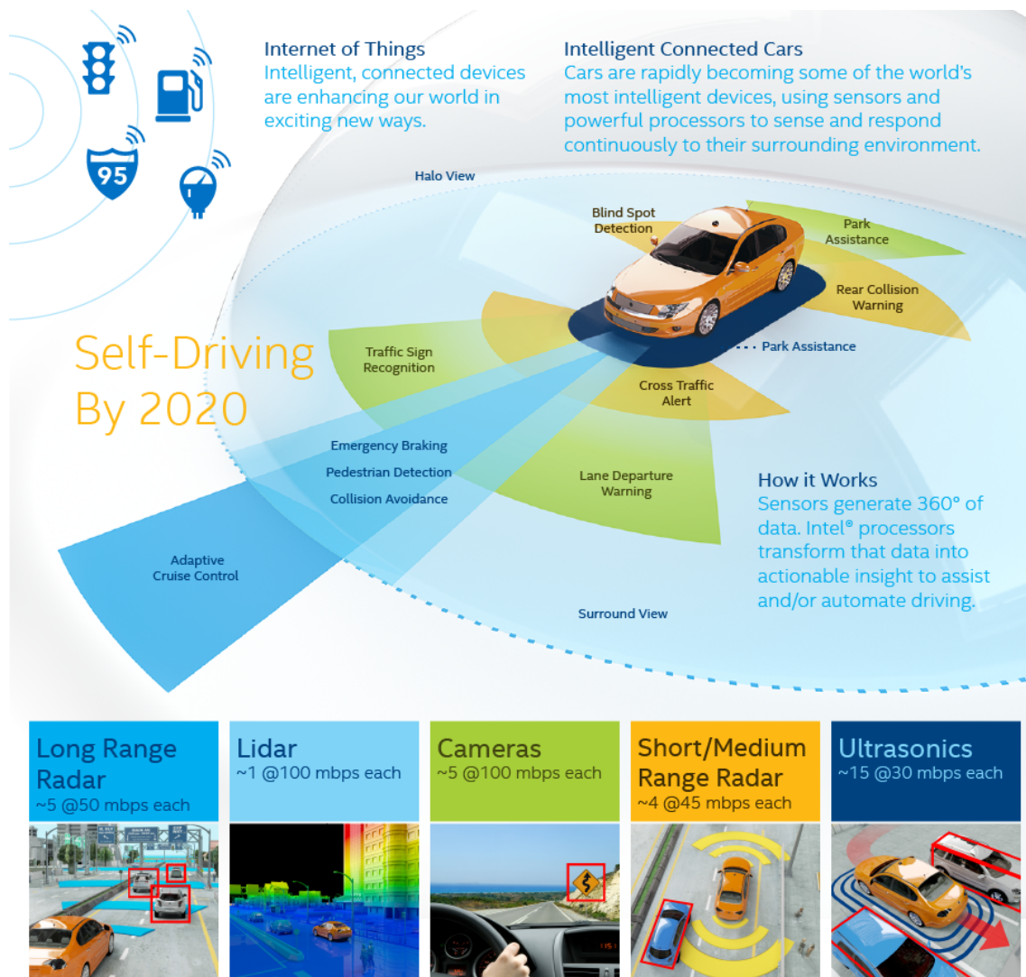
Figura 6: Ilustração da funcionalidades prevista na plataforma para veículos inteligentes lançados pela Intel (INTEL, 2016).
