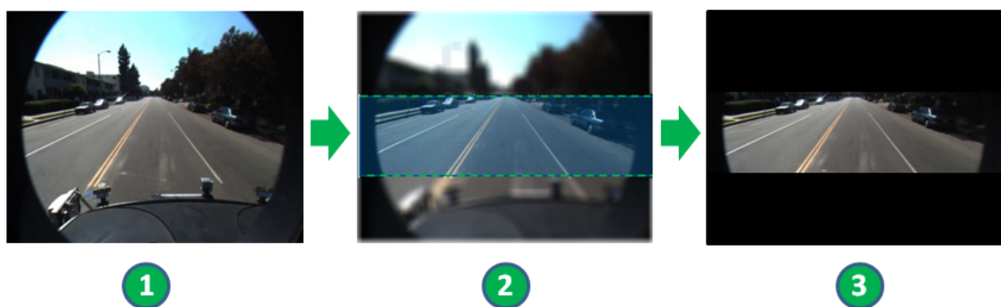
Figura 36: Ilustração do procedimento separação da imagem de interesse 1 (ROI-1). A imagem (1) representa a imagem da pista obtida pelas câmeras, a imagem (2) delimita a região de interesse 1 e a imagem (3) representa a região de interesse extraída.
