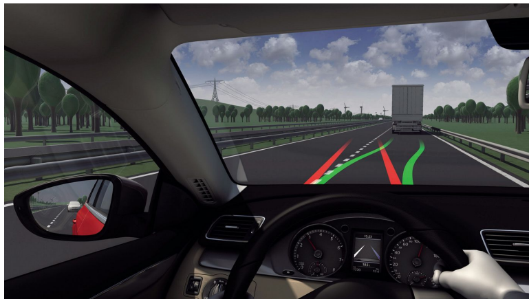
Figura 2: Ilustração do assistente de detecção de faixas de sinalização da Volkswagen (CARICOS, 2012).
