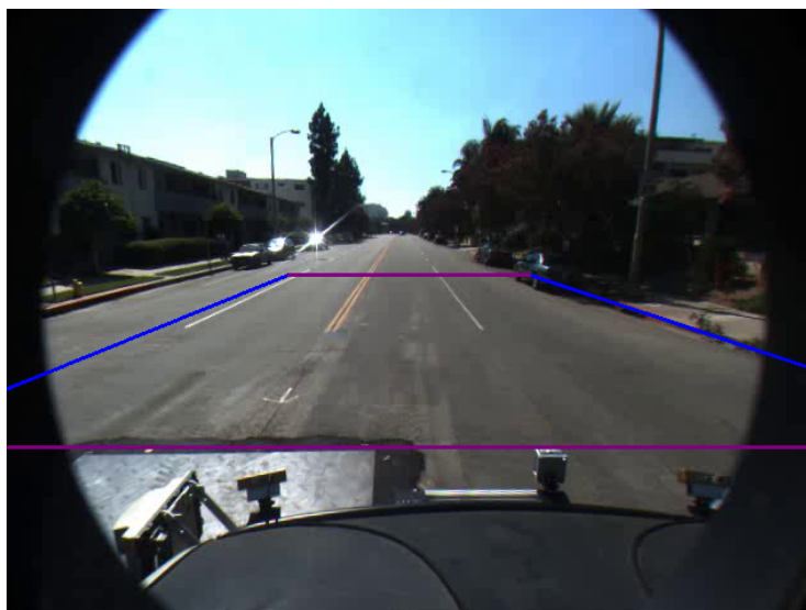
Figura 48: Ilustração dos limites usados para definir a região da pista em que as faixas de sinalização e borda da pista detectadas são consideradas corretas.
