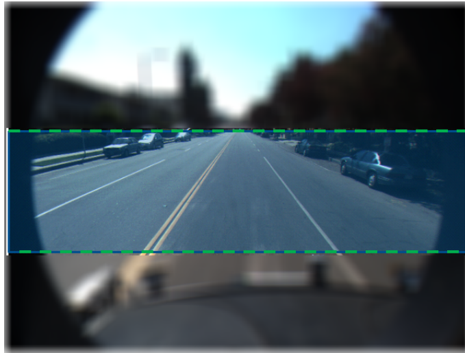
Figura 12: Ilustração da primeira região de interesse (ROI-1) que isola a região da imagem onde a pista está contida utilizada no banco de dados da Caltech. Adaptado de (ALY, 2008).
