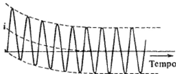
Figura 8 - Composição das correntes transitória e permanente
