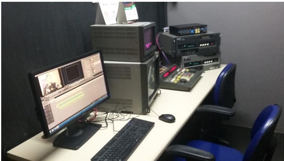
Imagem 4: Ilha de Edição não-linear rodando software Edius. Uma das ilhas que compõem o novo sistema de edição digital da TVE-RS
