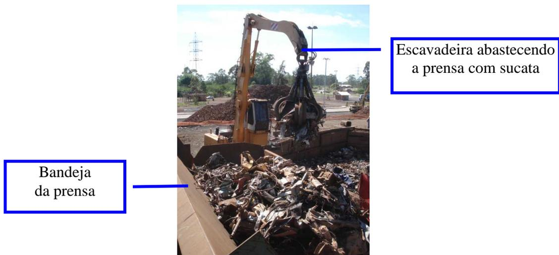
Figura 1.2: Abastecimento da bandeja da prensa.
