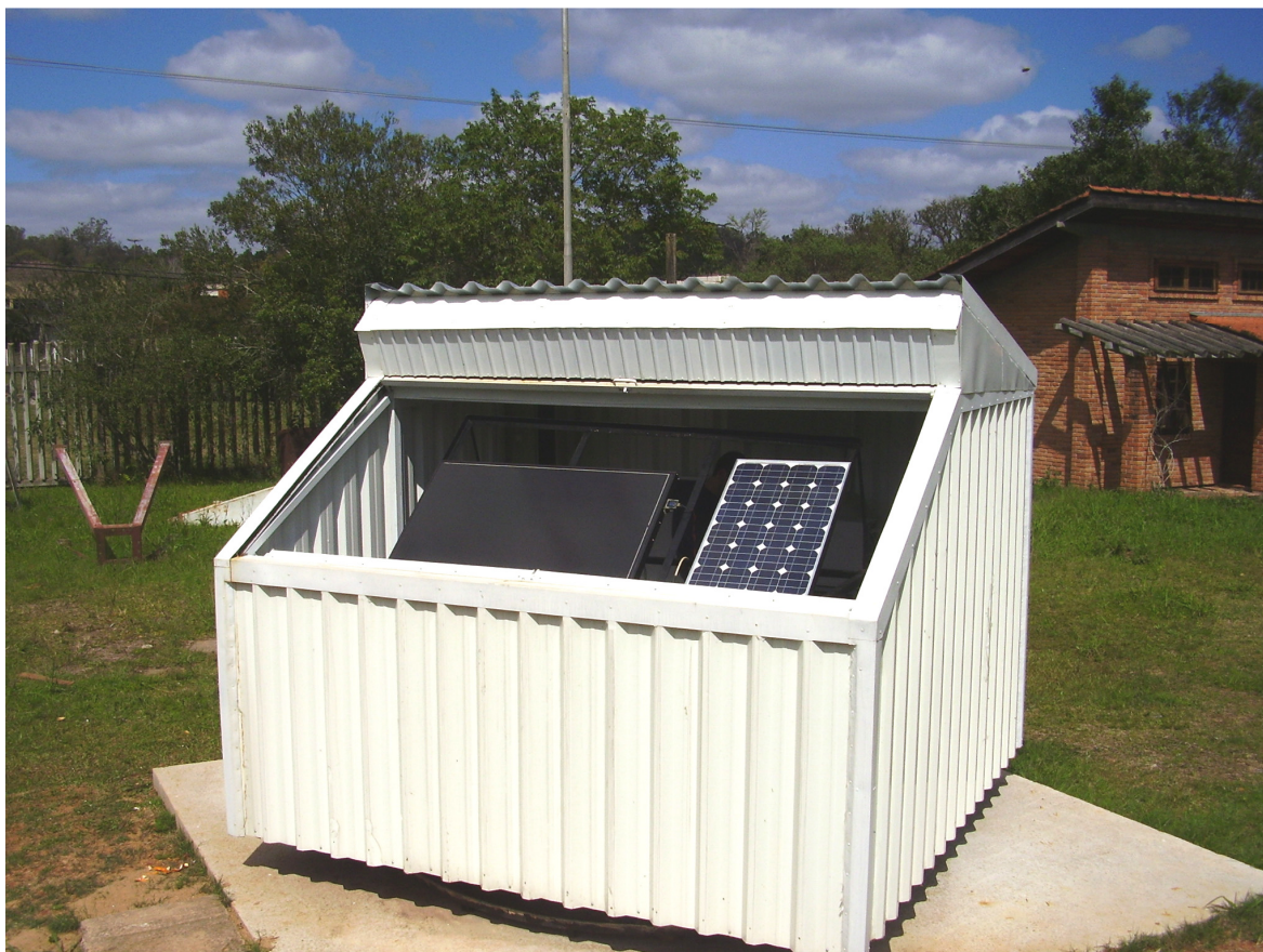
Figura 4.10 – Foto da câmara utilizada para ensaios de módulos fotovoltaicos.
