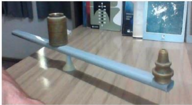
Imagem 3 – Material usado para atividade de avaliação sobre o conceito de torque
