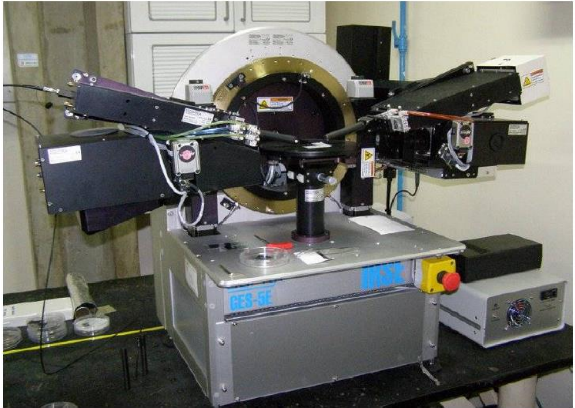
Figura 19 - Elipsômetro Espectral SOPRA GES-5E (Laboratório de Lasere óptica - UFRGS).
