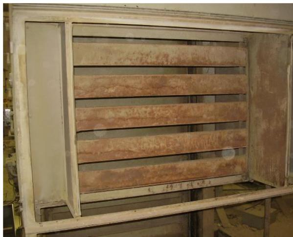
Figura 2.8: Grades internas de distribuição de ar quente.
