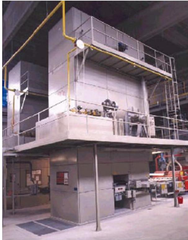
Figura 2.4: Exemplo de secador vertical contínuo. Fonte Eliane Revestimentos Cerâmicos, secador EVA 140-Sacmi, instalado na Unidade II.
