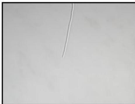
Figura 2.16: Defeito Ra em peça cerâmica.
