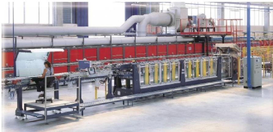
Figura 2.15: Setor de Classificação das peças Cerâmicas
