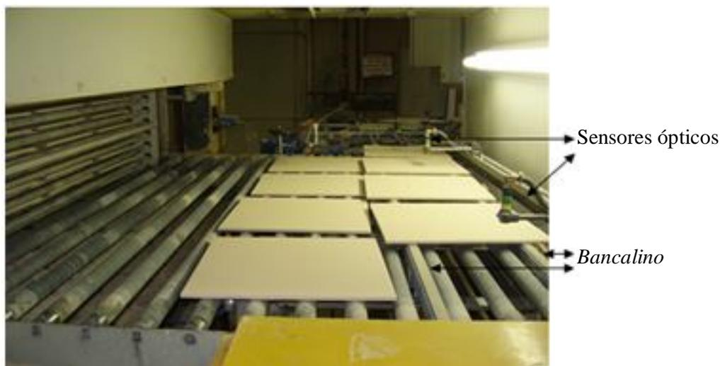
Figura 2.11: Saída do Secador.
