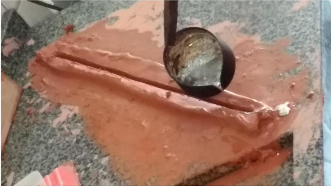
Chumbo derretido sendo introduzido no molde de argila.
