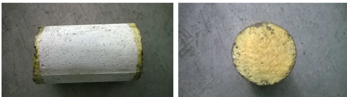
Figura 22 - Impermeabilização das extremidades dos corpos de prova para carbonatação (Fonte: Autor).
