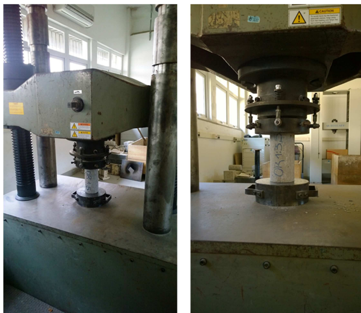
Figura 20 – Equipamento utilizado na ruptura dos corpos de prova (Fonte: Autor).
