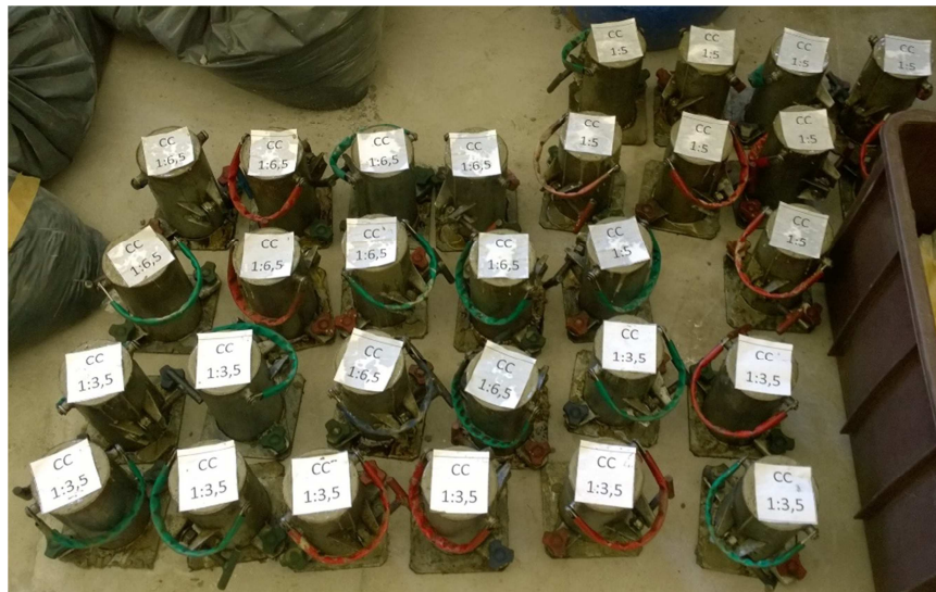
Figura 18 – Corpos de prova após adensamento na mesa vibratória para a dosagem do concreto sem adição de resíduo (Fonte: Autor).
