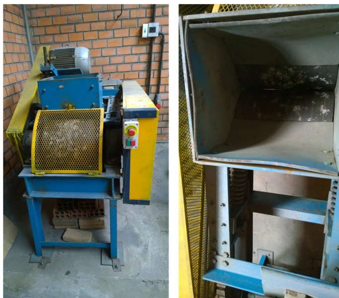
Figura 10 - A esquerda uma visão total do moinho de rolos e a direita, uma visão dos rolos da moagem (Fonte: Autor).
