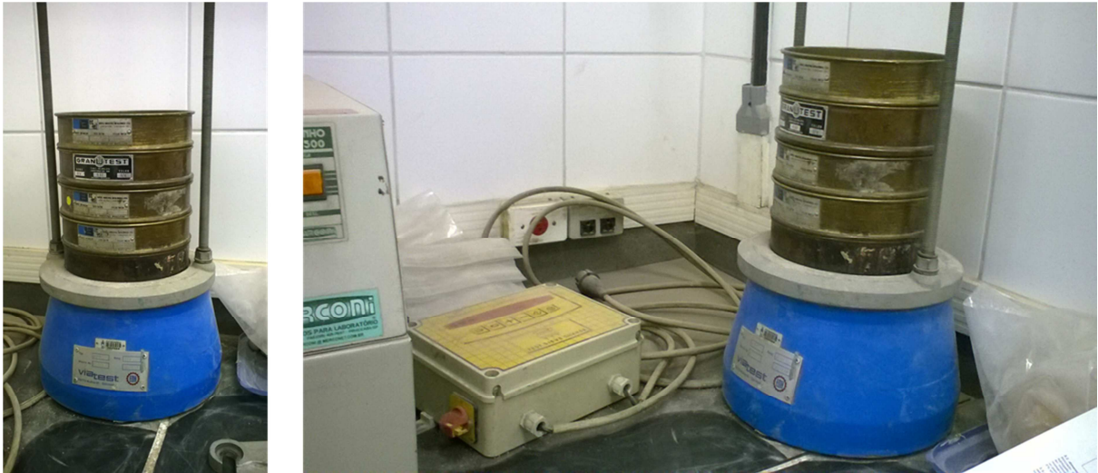
Figura 13 – Conjunto de agitador e peneiras utilizado no ensaio de determinação da curva granulométrica (Fonte: Autor).
