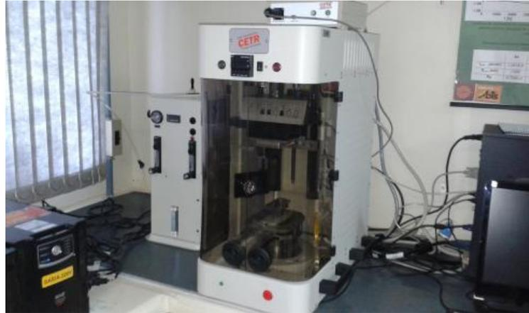
Figura 3.4 – Tribômetro utilizado para os ensaios
