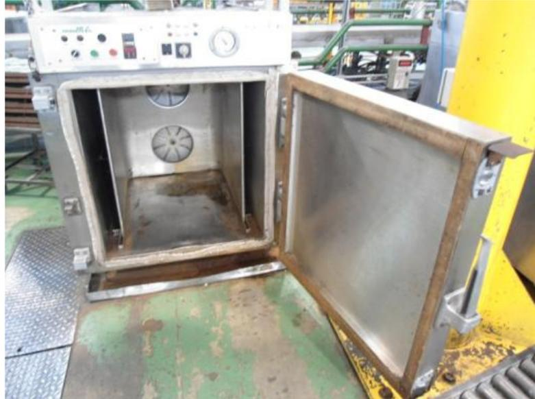
Figura 3.3 – Máquina para tratamento criogênico.
