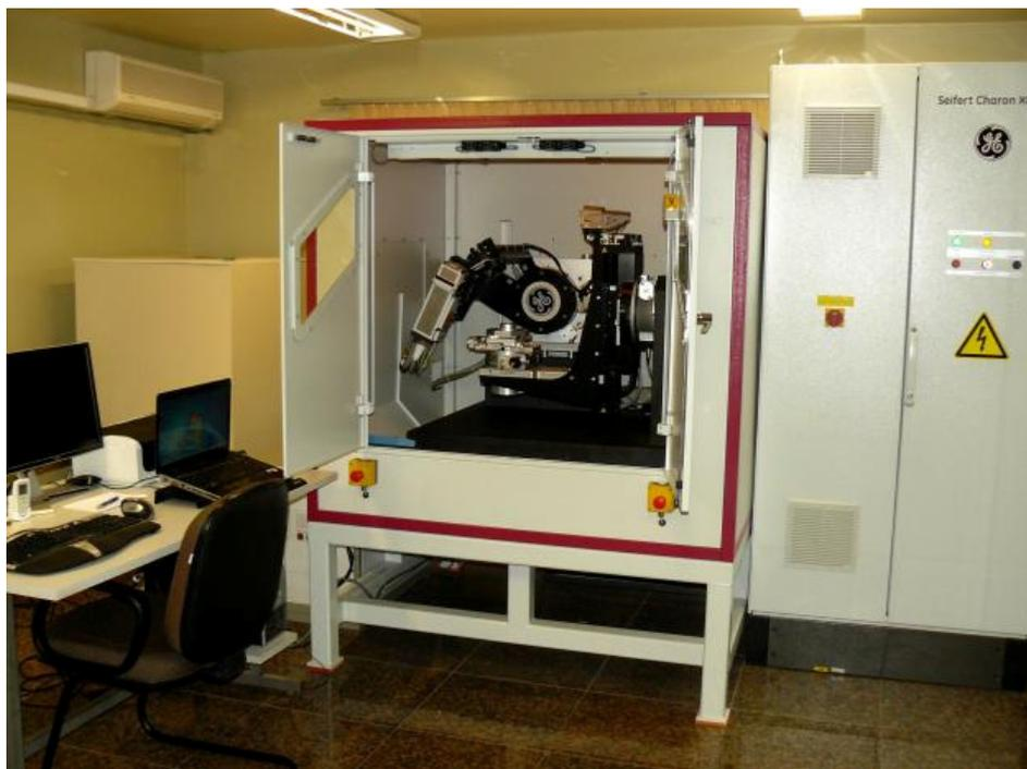
Figura 3.6 – Difratorômetro utilizado
