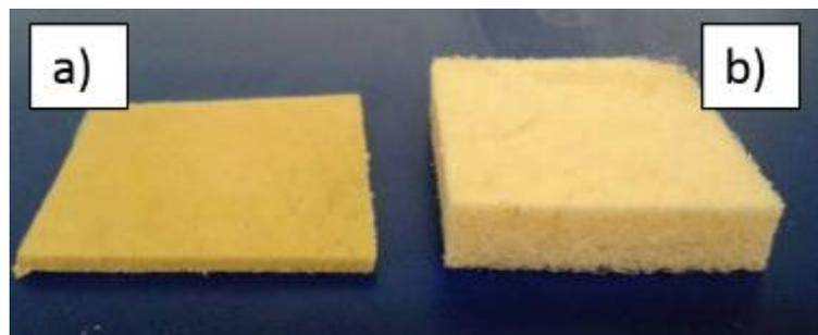
Figura 10: Amostras de PLA (a) pré-forma e (b) espuma.
