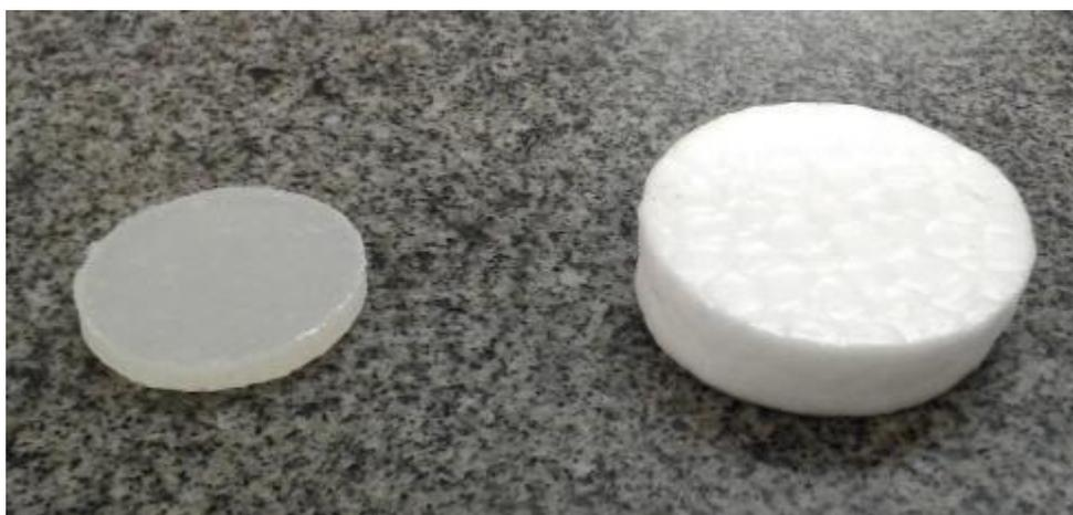
Figura 44: Pré-forma e espuma de EVA expandida com  $\text{CO}_2$  supercrítico.
