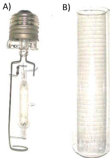
Figura 10 - Lâmpada de vapor de mercúrio de 250 W (A) e bulbo de quartzo (B).
