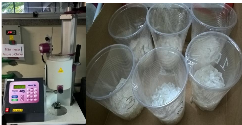
Figura 25. Equipamento e amostras coletadas no ensaio para determinação do índice de fluidez
