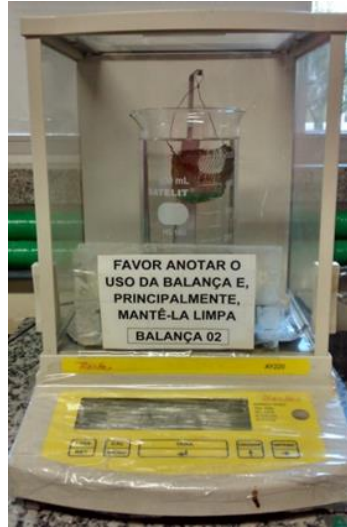
Figura 22. Aparato para realização do ensaio para determinação da densidade das amostras
