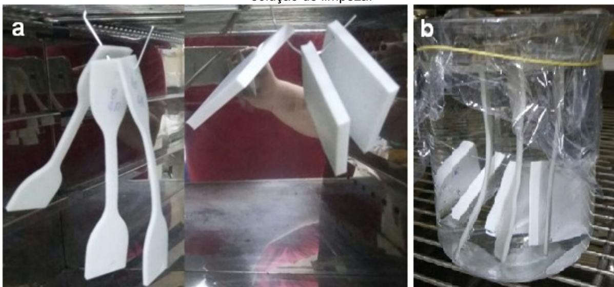
As amostras foram submetidas a aquecimento em estufa com circulação de ar, a 105 °C, essa temperatura simula um envelhecimento acelerado sem alterar as características inerentes dos compostos, durante sete dias (168 h). Após esse tempo as amostras foram condicionadas à temperatura ambiente por 48 h, antes da realização de testes de tração, conforme ASTM D 573 – 04 (2010). A alteração dos valores da propriedade mensurada após o envelhecimento foi expressa em porcentagem segundo a Equação (1):
