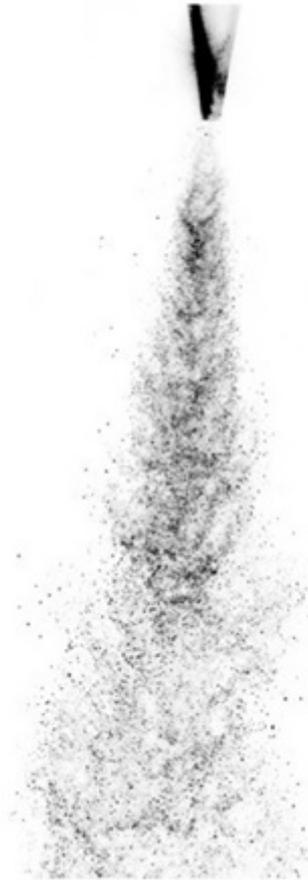
Figura 6. 3 - Imagem dos cones de aspersão produzidos a 120 mm de altura, sem etanol da solução  $\text{La}_{0,9}\text{Sr}_{0,1}\text{Co}_{0,2}\text{Fe}_{0,8}\text{O}_3$ : (A) Imagem obtida pela câmera rápida e tratada.
