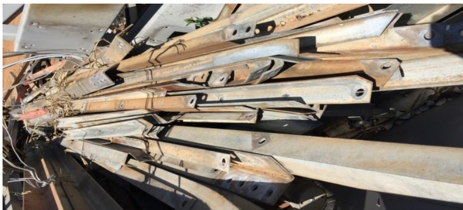
Figura 3.9 - Impureza intrínseca: material galvanizado.
