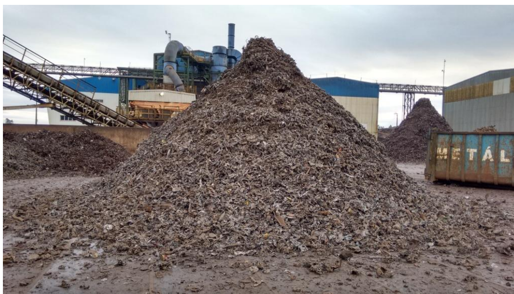
Figura 3.19 Sucata Shredder. Fonte: Cortesia Gerdau.
