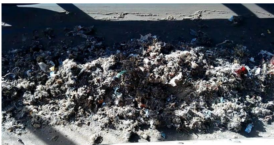
Figura 3.10 Impureza extrínseca retirada no despoeiramento do Shredder.
