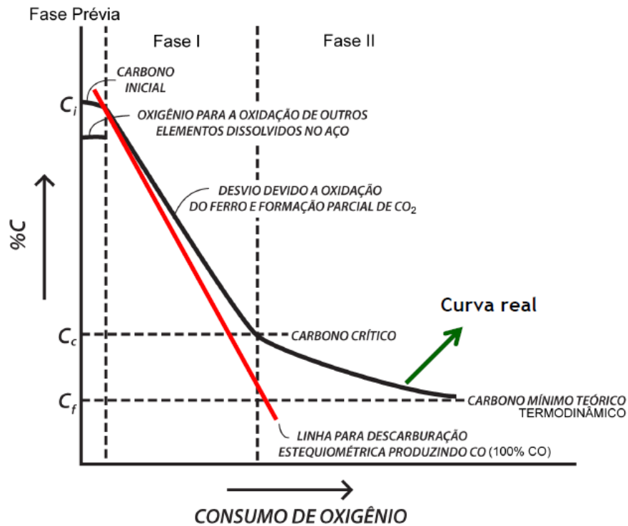
Figura 5.6 Curva de carbono crítico durante a descarbonização.
