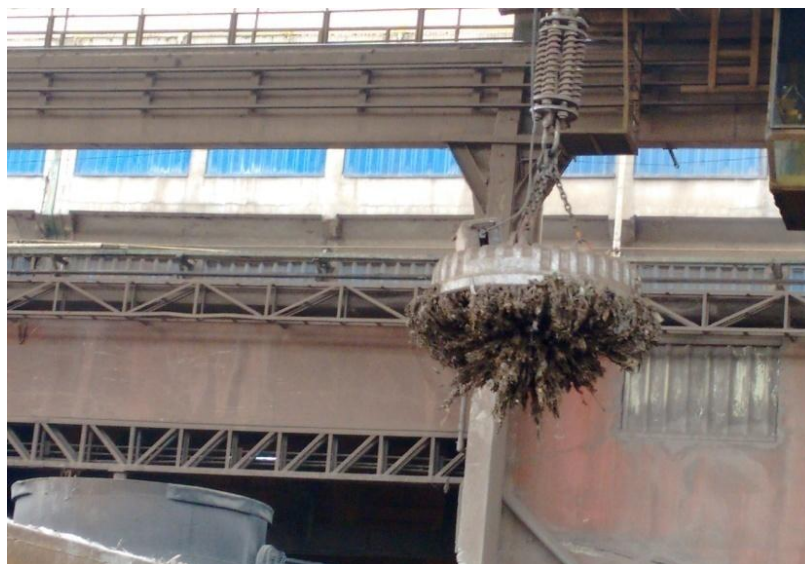
Figura 4.4 Carregamento da SSHR para o cestão utilizando eletroímã. Fonte: Cortesia Gerdau.
