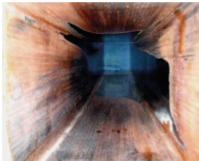
Figura 2.35 Desgaste severo e irregular de molde causado por romboidade. Fonte: BAKSHI (2014).
