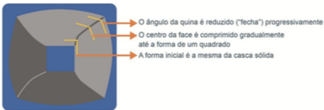
Figura 2.10 Tecnologia Convex, mostrando o fechamento angular do raio de canto do molde. Fonte: OGASAWARA et al, 2013.
