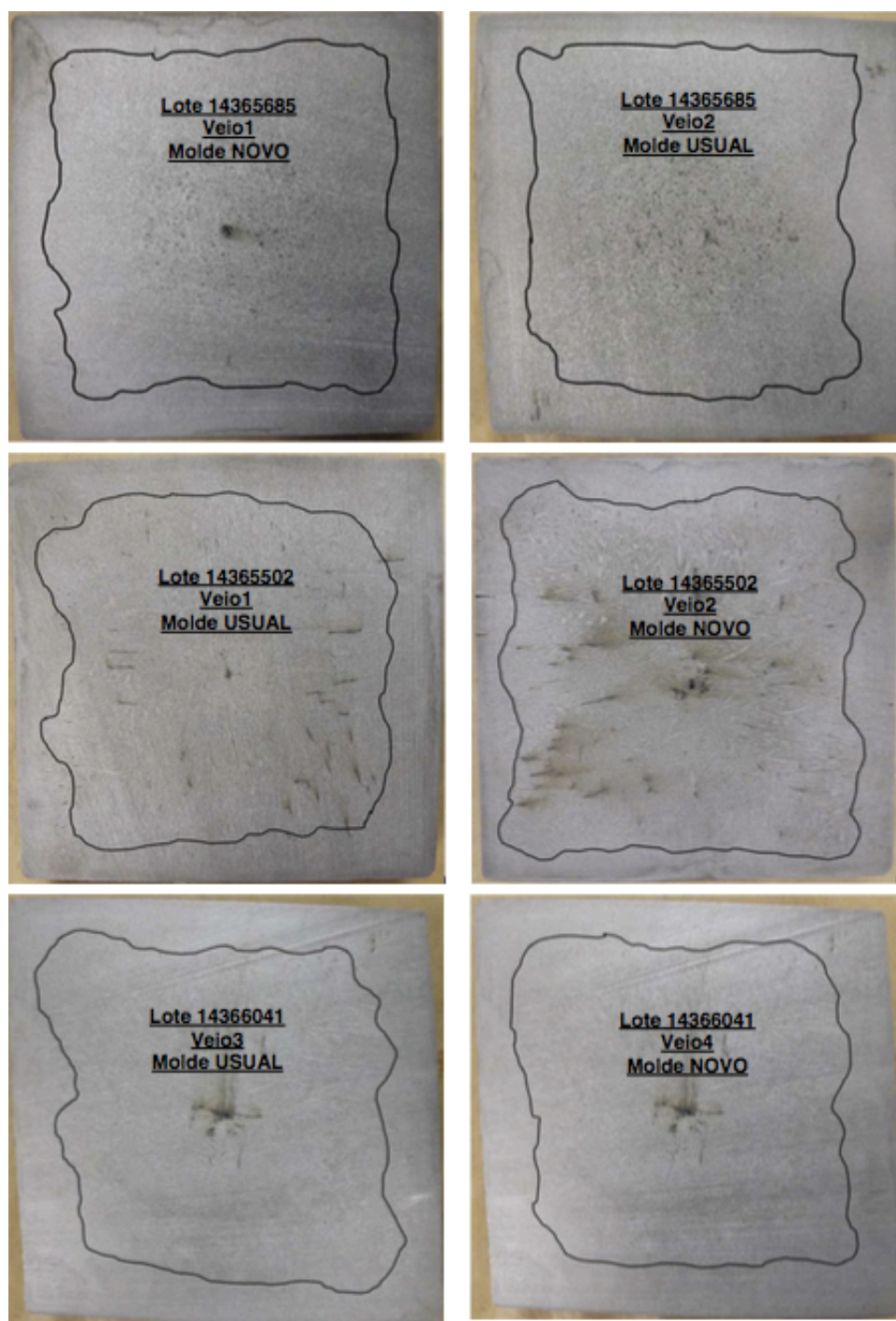
Figura 4.1 Imagem ilustrando as amostras utilizadas e o traçado indicando a zona coquilhada.
