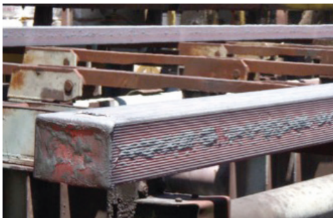
Figura 2.13 Tarugo com ondulação na superfície resultante do lingotamento em um molde Wave . Fonte: BAKSHI, 2014.
