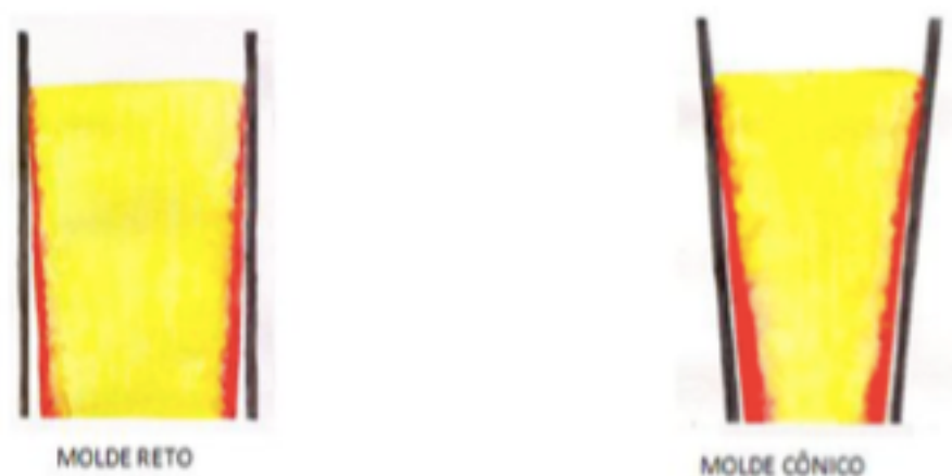
Figura 2.8 Molde reto e molde cônico. Fonte: OGASAWARA et al, 2013.
