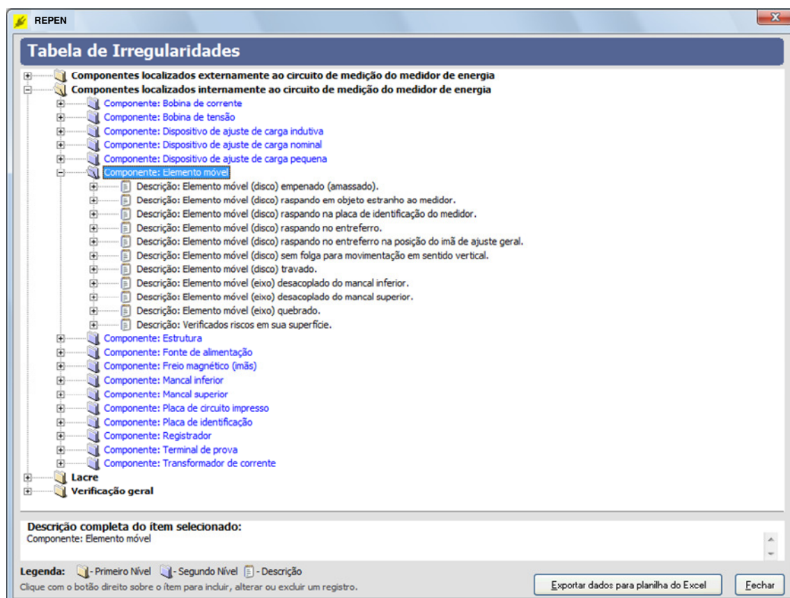
Figura 36. Representação parcial das irregularidades para o elemento móvel
