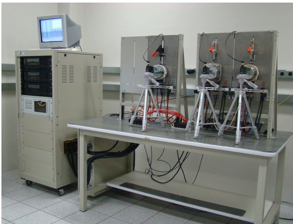
Figura 20. Banca de calibração padrão de MEEs
