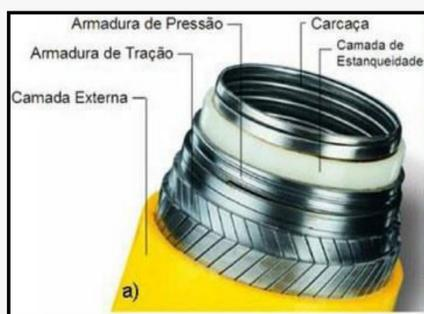
Figura 1: Visualização estrutural da seção de um riser flexível. Fonte: PETROBRAS.
