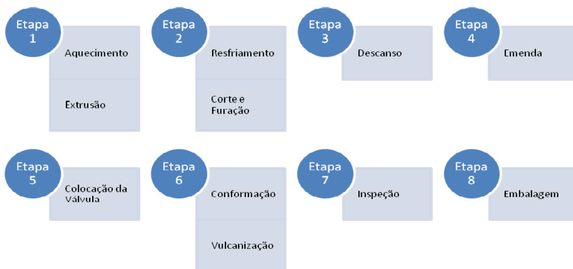
Figura 5 – Etapas da Linha de Produção de Câmaras Pneumáticas.
