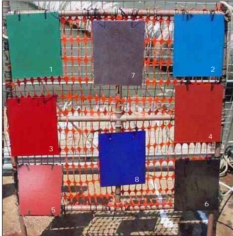
Figura 22 – Estrutura de plástico com as placas de aço revestidas, após uma semana de imersão em ambiente marinho
