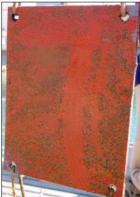
Figura 61 – Aspecto da placa 41 revestida com a tinta comercial Intersmooth 360 após 23 semanas de imersão em ambiente marinho
