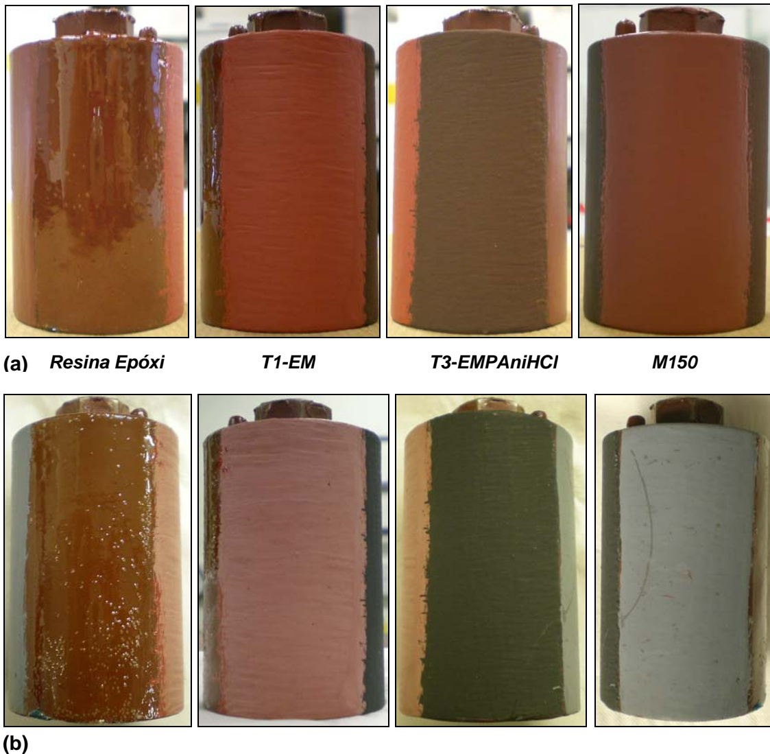
Figura 40 – Revestimentos Resina Epóxi, T1-EM, T3-EMPA ni HCl e M150 (a) antes do ensaio; (b) após 576 h de imersão em modo dinâmico
