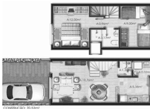
Figura 33: Planta baixa UH (2 dormitórios) – empreendimento SC
