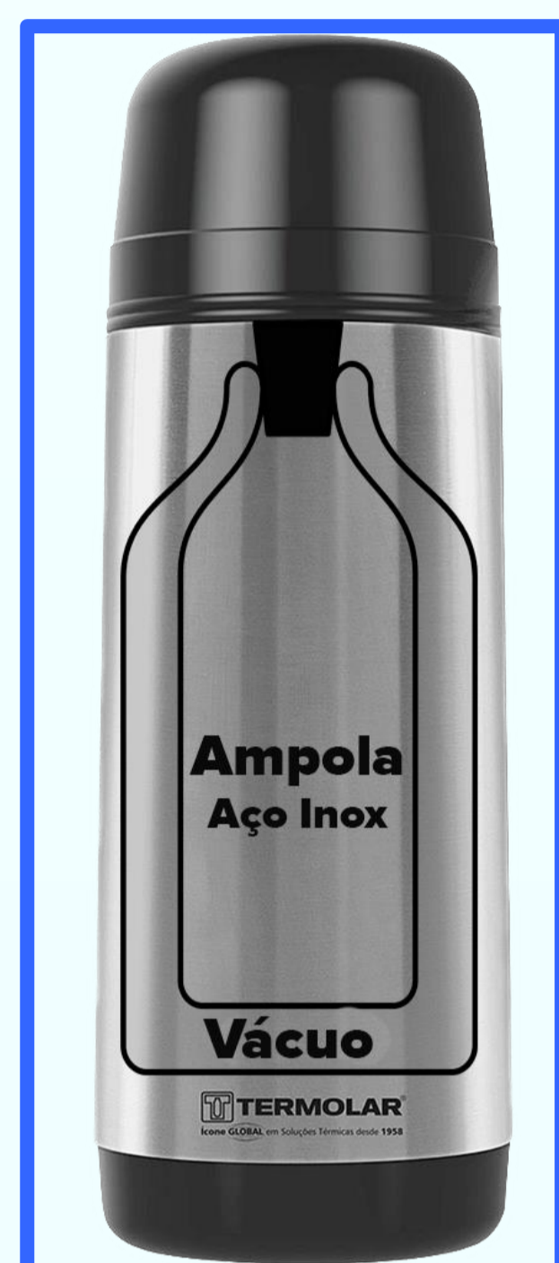
Fig. 1: Representação esquemática referente à montagem das garrafas térmicas estudadas. A partir da ampola interna, fabricada em Aço Inox ABNT304, foram produzidos os corpos de prova.
