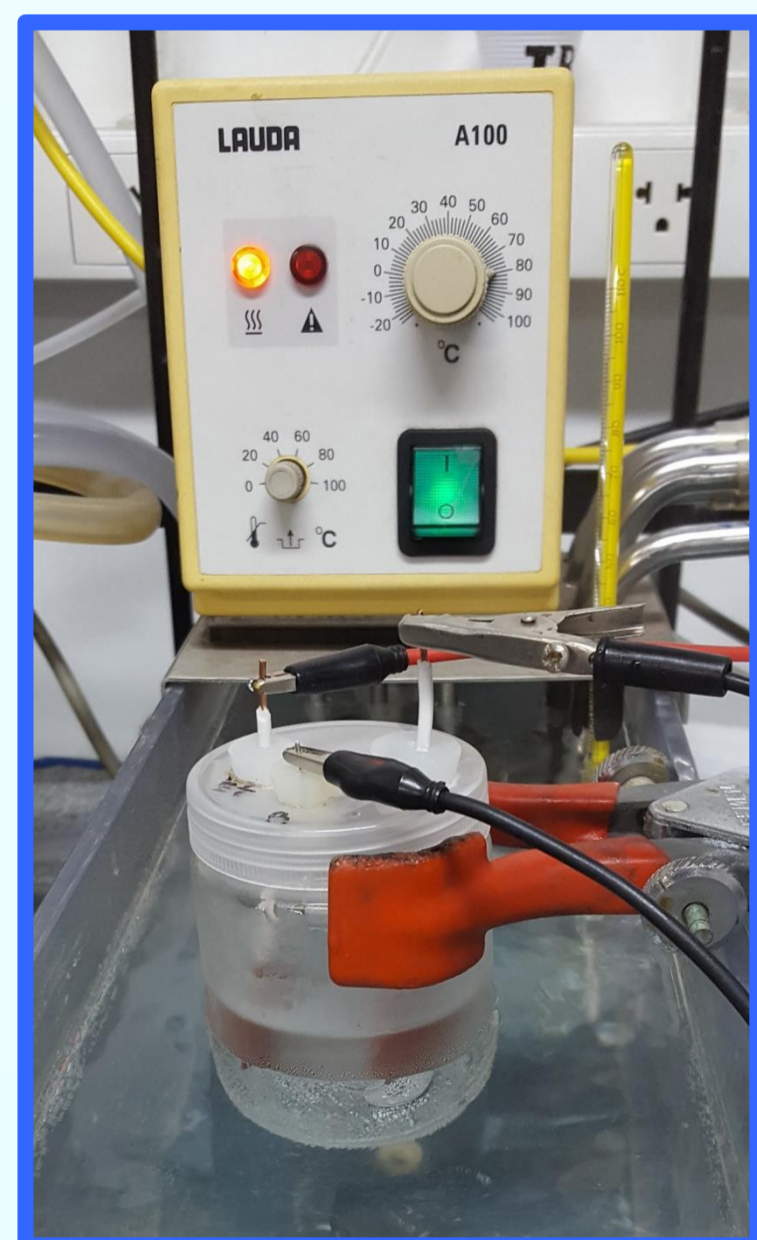
Fig. 2: Célula eletroquímica utilizada no estudo em banho termostático para ajuste da temperatura do sistema.
