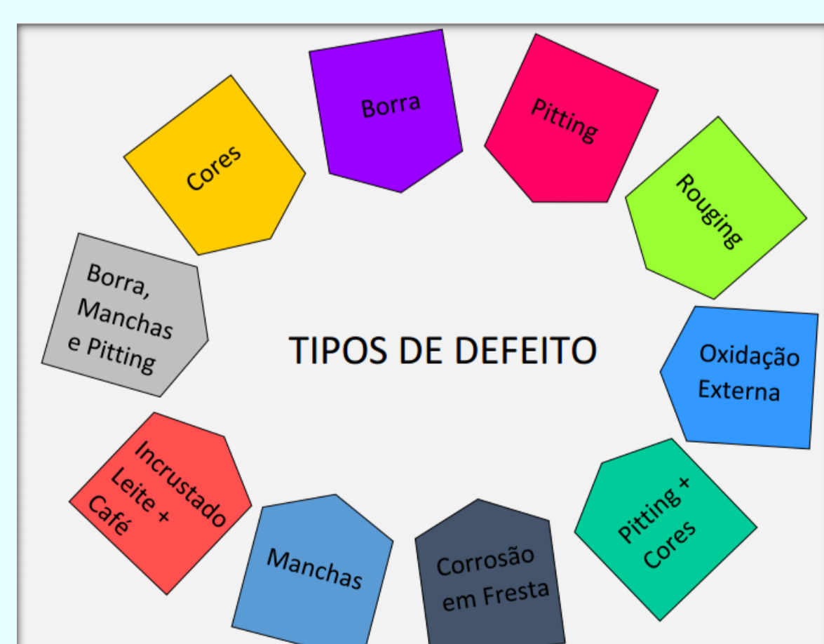
Fig. 3: Classificação dos tipos de defeito encontrados nas garrafas utilizadas no estudo.
