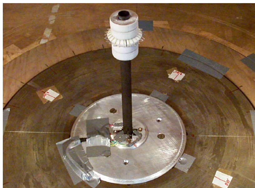
Figura 4.32 – Modelo aeroelástico fixado na mesa dinâmica M-II.
