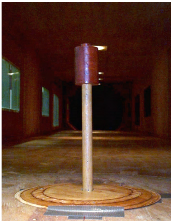
Figura 4.7 – Modelo de madeira no interior do túnel de vento, sem simuladores da rugosidade do terreno.
