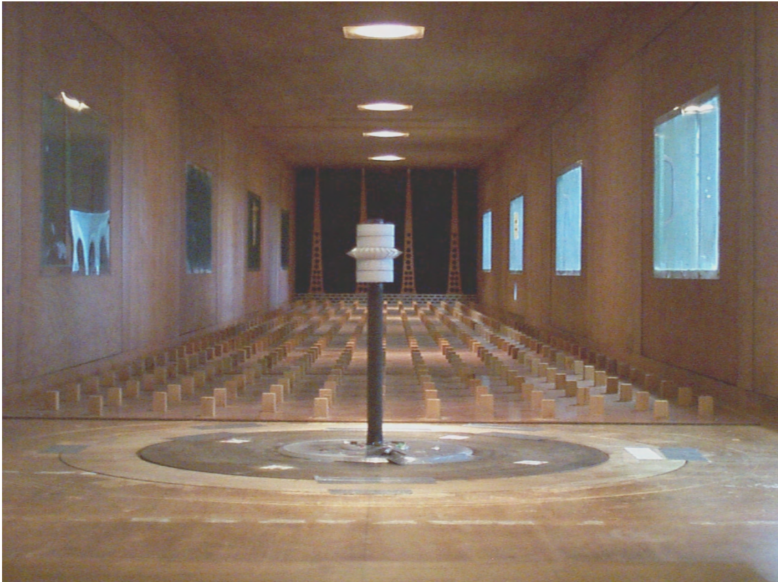
Figura 4.31 – Vista do modelo aerolástico no interior do túnel de vento com os elementos para simulação das principais características do vento natural.
