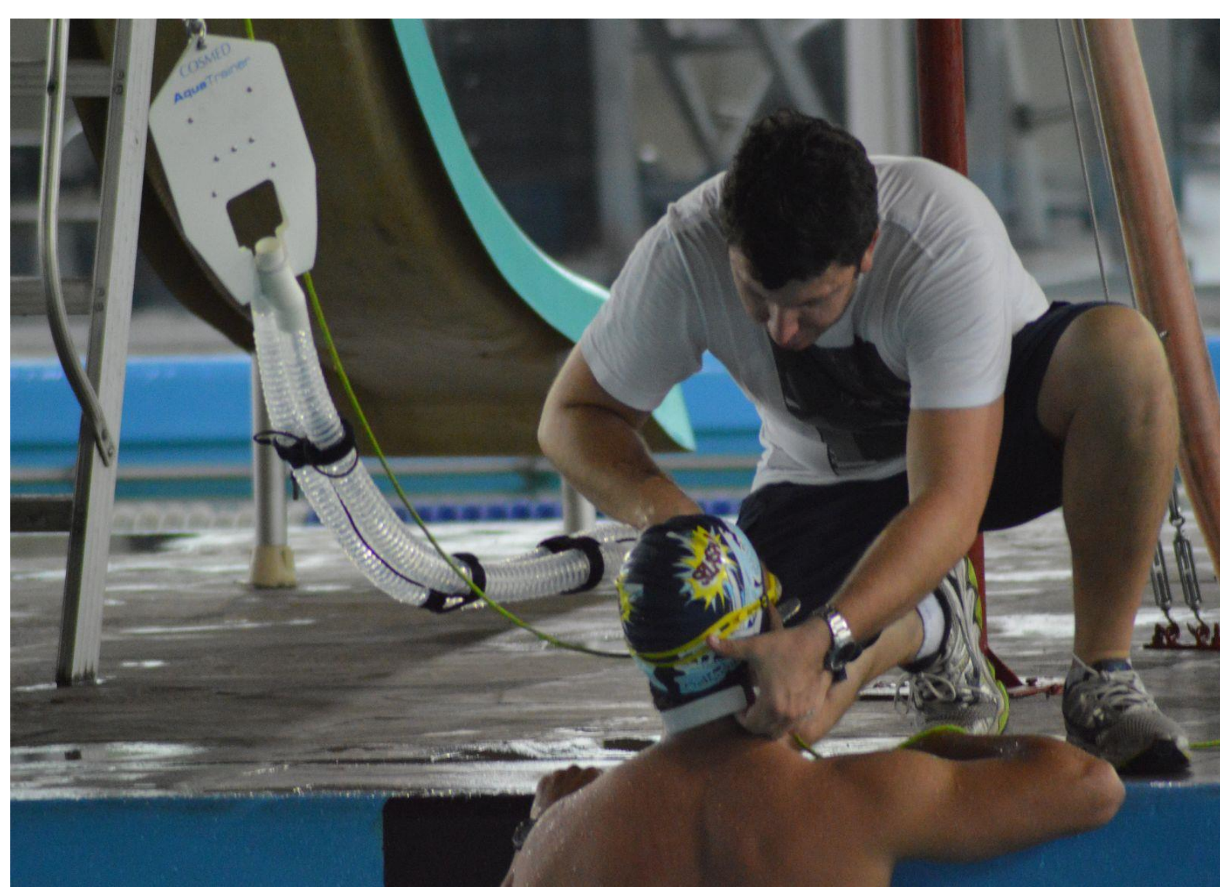
Figura 1 (acima) e Figura 2 (ao lado): colocação e utilização de esnorquel para medida de consumo de oxigênio em natação.
