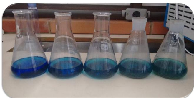
Figura 1 - Variação da coloração da solução após o teste de equilíbrio com o bagaço de malte seco
