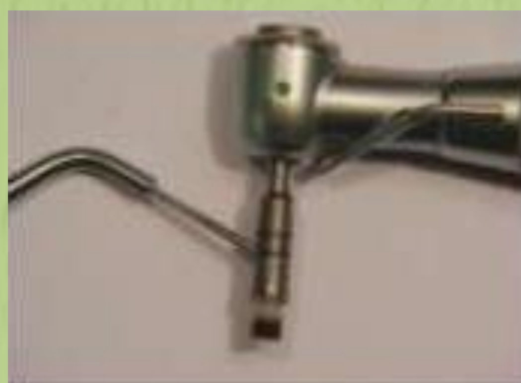
Figura 4: Brocas trefinas adaptadas a uma micro retífica livre.
