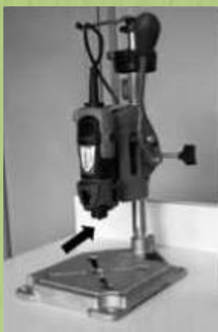
Figura 3: Brocas trefinas adaptadas a uma micro retífica presa em base fixa.
