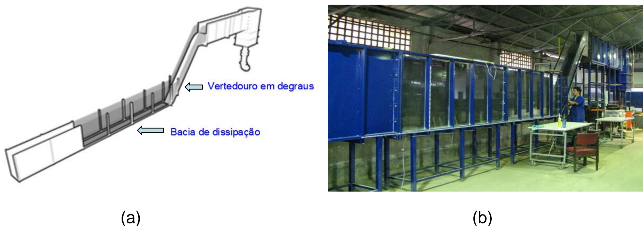
Figura 2: Esquema (a) e foto (b) do modelo físico utilizado.
