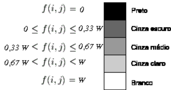
Figura 2.1: Exemplo de um mapeamento entre os valores armazenados na matriz F e as suas respectivas representações em tons de cinza (BATCHELOR; WALTZ, 2001).
