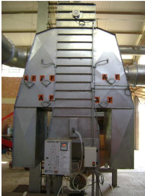
FIGURA 2. Secador de grãos, tipo cascata efluxo de ar cruzado, com capacidade para 12 sacos, Eldorado do Sul, RS 2012.
