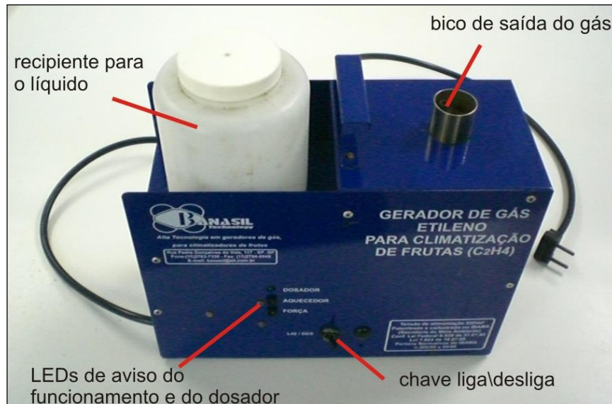
Figura 23 - Equipamento gerador de etileno, identificando suas partes.
