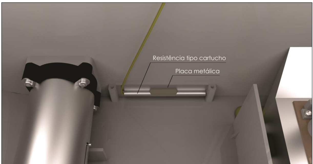
Figura 69 - Estrutura de aquecimento.
