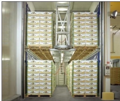
Figura 26 – Câmara de desverdeamento automatizada com capacidade para 20 toneladas.
