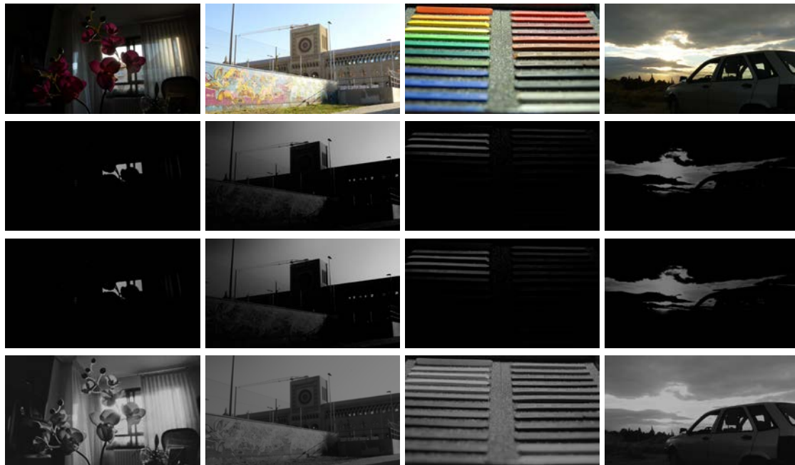
Figura 5.4: Comparação entre espaços de cor RGB e CIELAB, considerando tanto casos de imagens escuras (esquerda e direita) quanto de imagens claras. Topo: Imagens de entrada. Segunda linha: BEFs geradas utilizando o filtro bilateral com o espaço de cor RGB. Terceira linha: BEFs geradas utilizando o filtro bilateral com o espaço de cor CIELAB. Quarta linha: Resultado do DRIM, comparando os dois resultados anteriores. Note que não há diferenças significativas detectadas pelo algoritmo.
