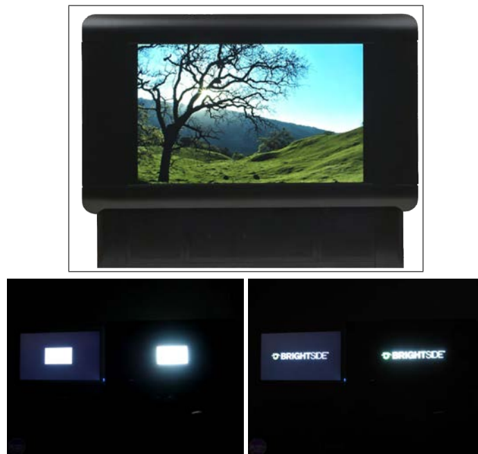
Figura 2.2: Representação do monitor Dolby DR37-P, desenvolvido pela Brightside Technologies. As imagens inferiores demonstram as capacidades de contraste de um monitor de alta definição convencional (esquerda) e de um monitor HDR (direita). Fonte: [BITTECH].
