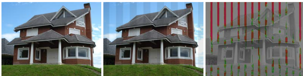
Figura 4.2: Detecção de diferenças pelo HDR-VDP [MANTIUK et al., 2004]. Esquerda: Imagem de referência. Centro: Imagem de teste, onde diferenças foram introduzidas. Direita: Resultado da detecção pelo algoritmo. Áreas em verde correspondem a uma probabilidade de detecção maior que 75%. Áreas em magenta correspondem a uma probabilidade de detecção maior que 95%.
