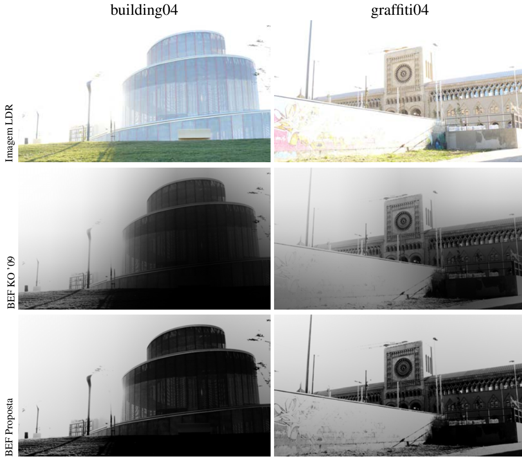
Figura 5.1: Demonstração da qualidade das BEFs geradas pela técnica proposta para imagens superexpostas. Topo: Imagens LDR superexpostas. Segunda linha: BEFs geradas utilizando o método de KOVALESKI; OLIVEIRA [2009]. Baixo: BEFs geradas com a técnica proposta. Observe a maior definição da BEF gerada utilizando a técnica proposta nas arestas em torno de áreas saturadas da imagem LDR, como a lateral do edifício na imagem building04 e o grafite na imagem graffiti04 .
