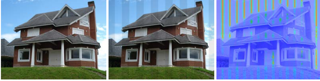
Figura 4.3: Detecção de diferenças pelo HDR-VDP2 [MANTIUK et al., 2011]. Esquerda: Imagem de referência. Centro: Imagem de teste, onde diferenças foram introduzidas. Direita: Resultado do algoritmo. Cores mais vibrantes correspondem a uma maior probabilidade de detecção.
